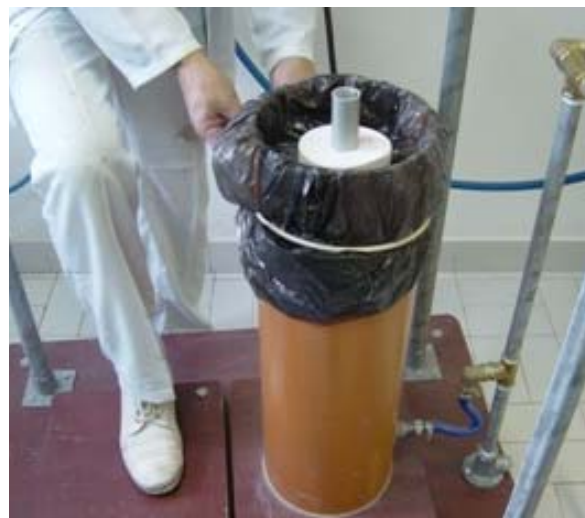
Das Vakuum verdichtet den Sand im PVC-Rohr
